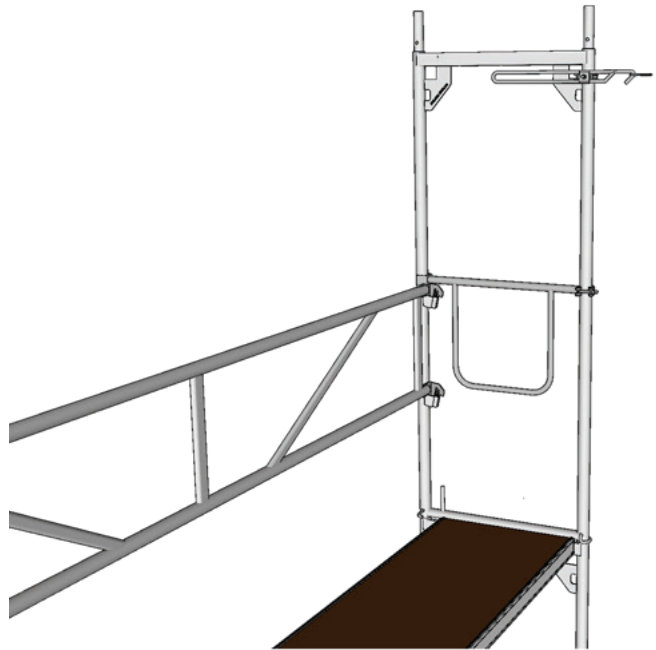
Fig. 21. Enderekkverk monteres i endene av stillaset. Koblingen festes til spiret nærmest veggen. Den andre enden hviler på rekkverket.
